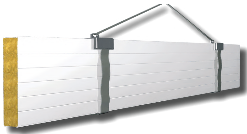
Рисунок 13: подвеска стеновых панелей при горизонтальном перемещении с помощью управляющего троса
