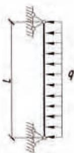
Схема нагружения – неразрезная многопролетная балка
