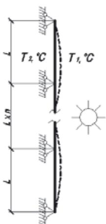
Схема температурного воздействия на стеновую панель
