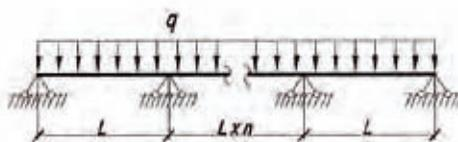
Схема опирания кровельных панелей
