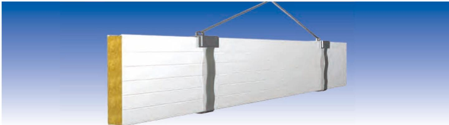
Рисунок 13: подвеска стеновых панелей при горизонтальном перемещении с помощью управляющего троса
