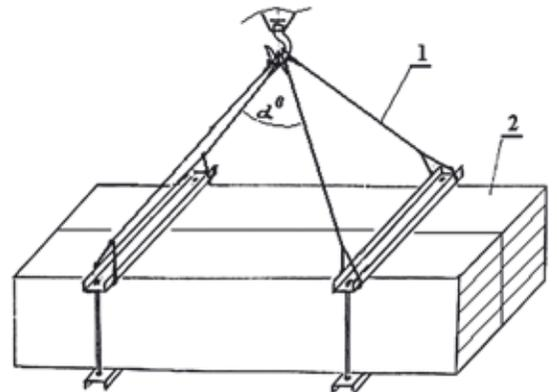
Рисунок 11: Схема строповки пакетов панелей с МВУ с применением траверсы
