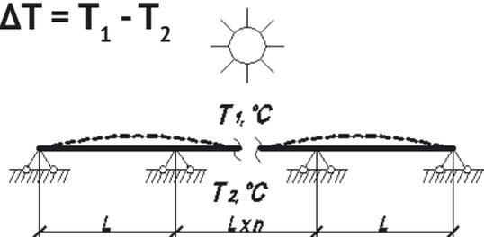
Таблица 12: максимально допустимая длина пролета (L, м) при неразрезной многопролетной схеме крепления кровельных панелей в зависимости от цветовой гаммы облицовки
