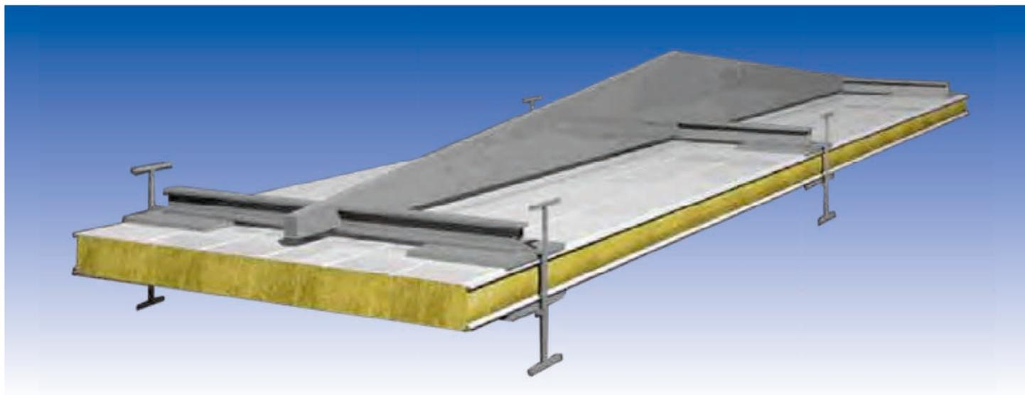
Траверса для подъема стеновых панелей длиннее 6м при вертикальном монтаже.
